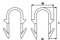
Фиксатор трубы на арматурной сетке
